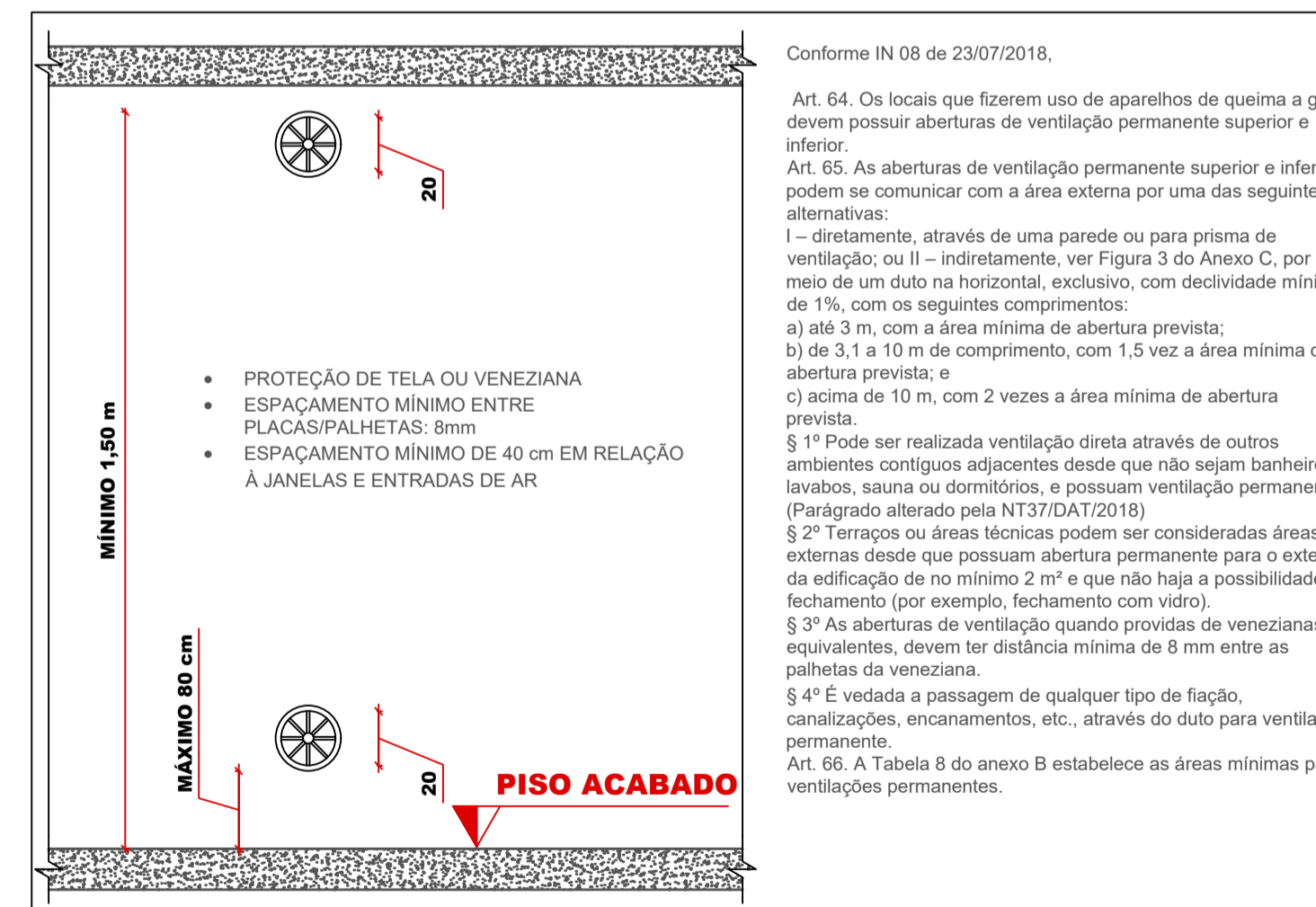
8 DETALHE VENTILAÇÃO SEM ESCALA
