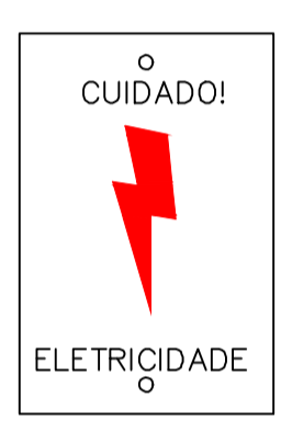
Detalhe Advertência nos quadros e medidores
