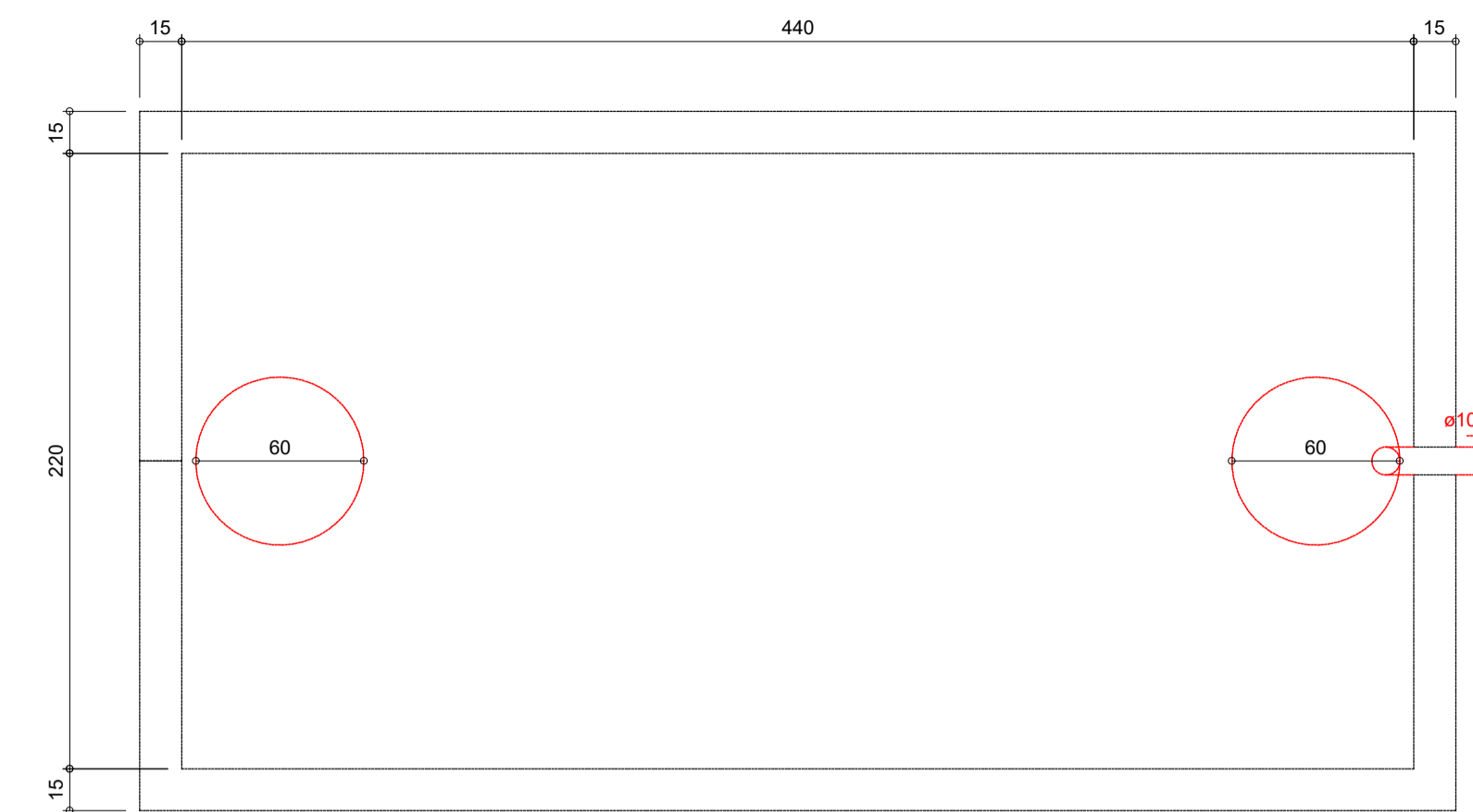
Tanque séptico Planta baixa - ESC. 1:25
