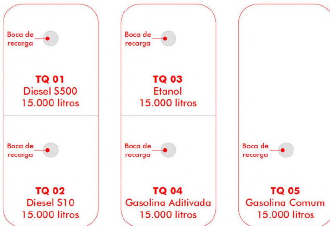
**Figura 27 – Detalhe de distribuição de litragem de cada tipo de combustível a ser comercializado no empreendimento**
