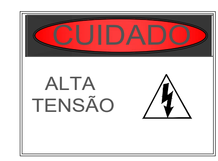
DETALHE DE PLACA DE ADVERTÊNCIA - ALTA TENSÃO sem escala
